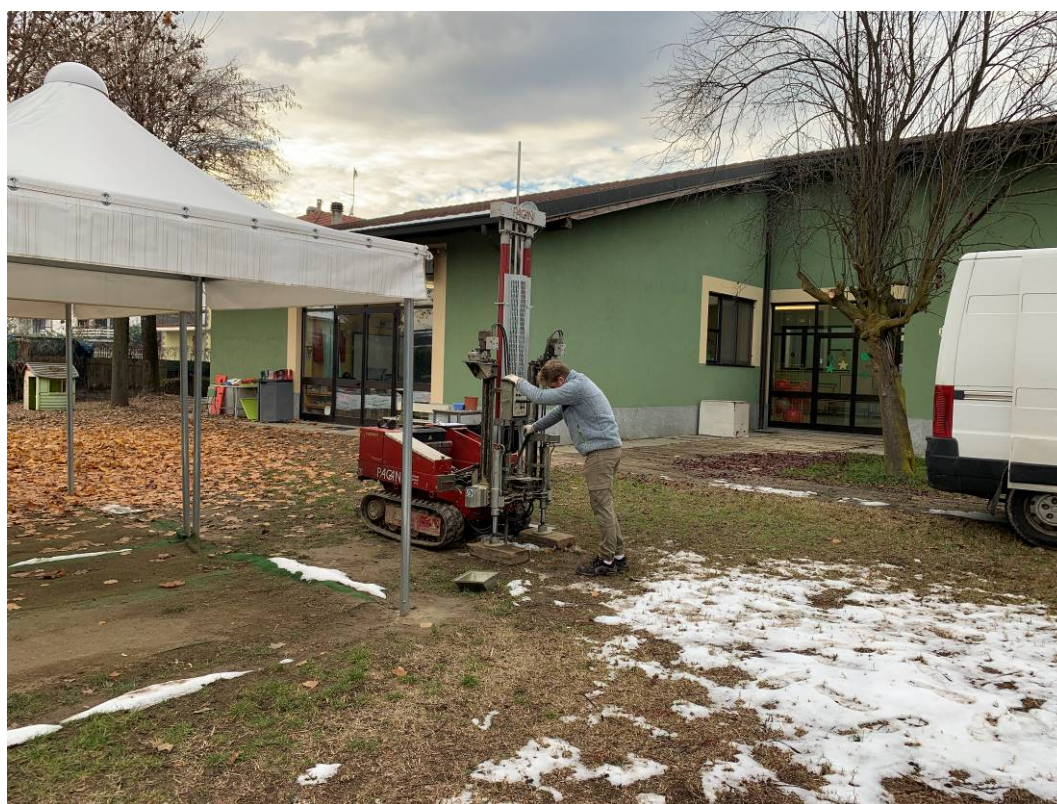
Foto 2 – L'esecuzione della prova penetrometrica DIN 2
