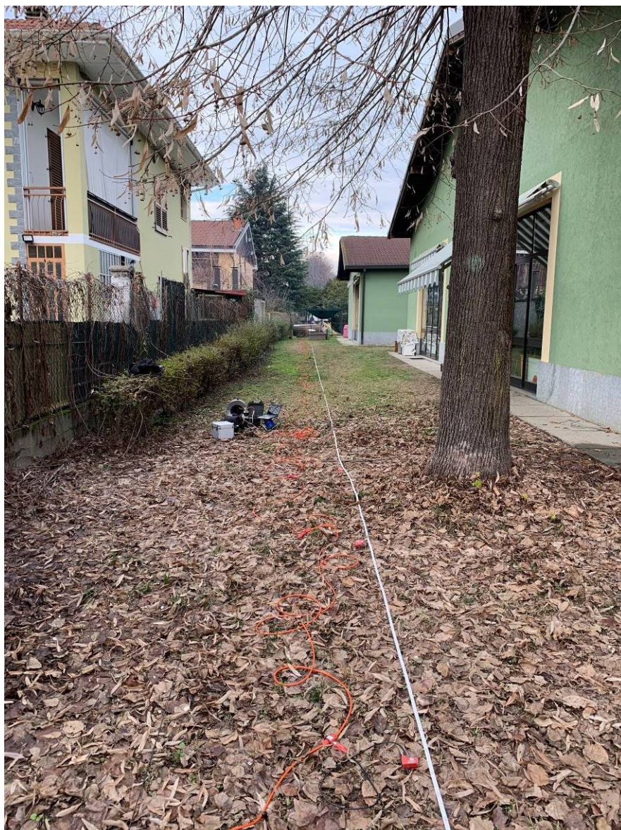
Foto 4 – L'esecuzione della prova sismica MASW
