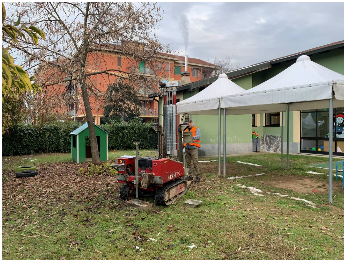
Foto 3 – L'esecuzione della prova penetrometrica DIN 3
