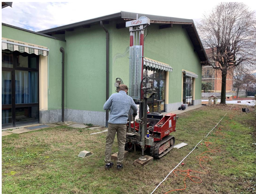
Foto 1 – L'esecuzione della prova penetrometrica DIN 1
